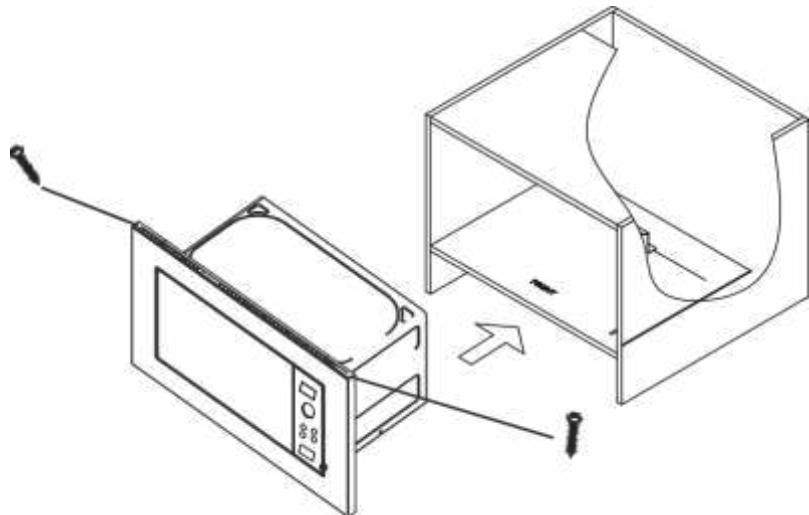
1. Вставьте микроволновую печь в нишу, держите прибор в горизонтальном положении, следите, чтобы расстояние до двух краев с обеих сторон было одинаковым. Вставьте винты (компл. 1) на верхнем ребре прибора и закрутите их в нишу.
