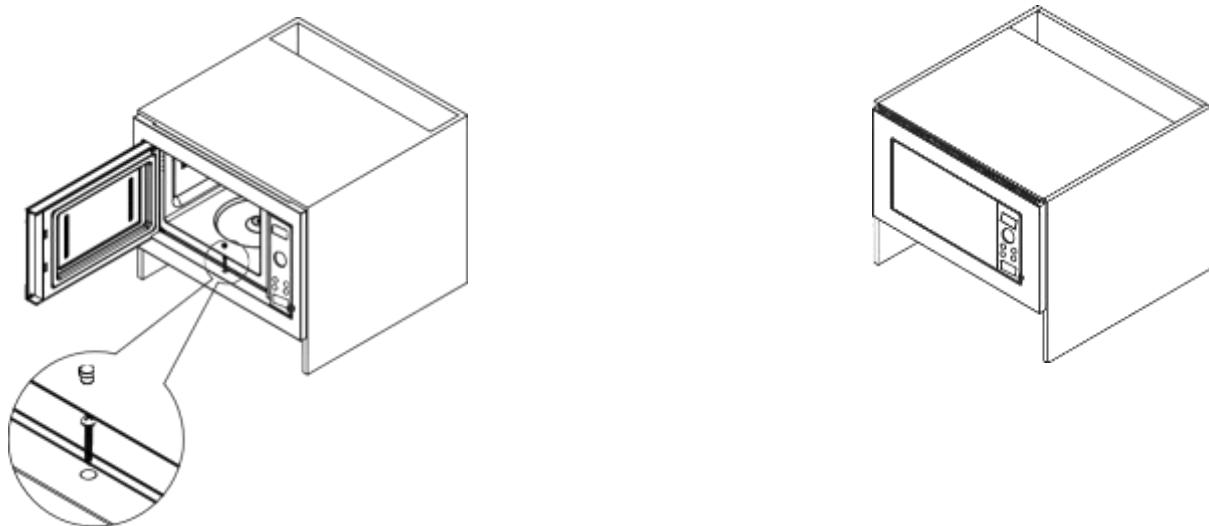
2. Откройте дверцу, вставьте винт (компл. 3) и закрутите его в нишу, затем поставьте колпачок.
