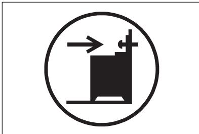
1. Установите защиту от опрокидывания на расстоянии 331 - 336 мм вниз от верхнего края прибора и на 80-85 мм от бокового края прибора в круглое отверстие на кронштейне. Привинтите его к твердому надежному материалу или прикрепите с помощью соответствующей арматуры (стены).
