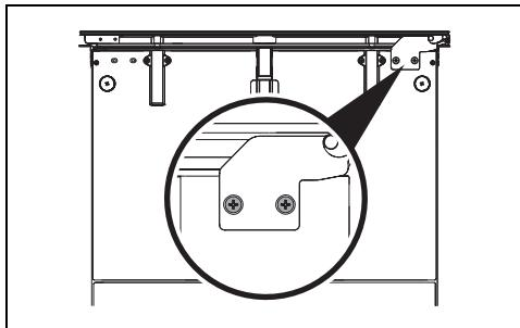
2. снимите два винта верхней петли.
