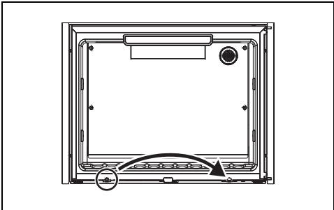
9. вновь установите дверь на прибор и закрепите верхние и нижние петли с помощью ранее снятых винтов.
