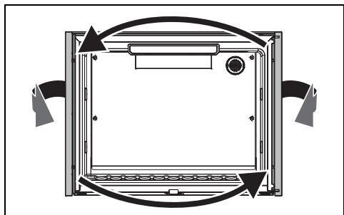
8. извлеките механизм толкателя двери и вставьте его в противоположное гнездо.
