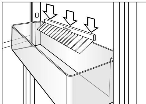
Пластиинки над полкой для бутылок лучше удерживают их при открывании и закрывании дверцы прибора.
