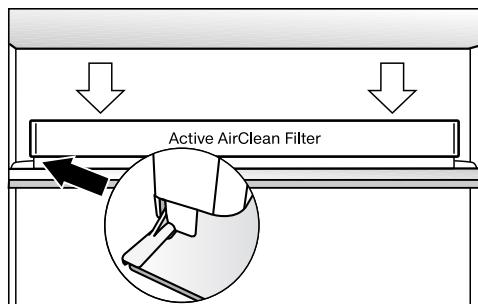
Держатель угольного фильтра надевается на заднюю защитную планку полки и может быть по желанию передвинут в другую позицию.
