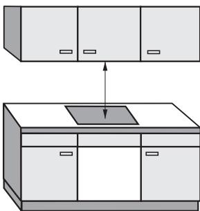
Необходимо соблюдать указанное производителем вытяжки безопасное расстояние между прибором и расположенной сверху вытяжкой. Если указания производителя вытяжки отсутствуют или над прибором устанавливаются, например, навесные полки из легко воспламеняющихся материалов, то необходимо соблюдать безопасное расстояние минимум 760 мм.
