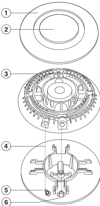
■ Установите головку горелки ③ на основание горелки ④ таким образом, чтобы термоэлемент ⑤ и поджигающий электрод ⑥ вошли в отверстия головки горелки.
