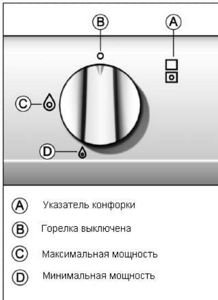
Нажмите на ручку, повернув ее против часовой стрелки до максимальной позиции (большое пламя «С»). Горелка загорается при установке на максимум. Затем по желанию установите на минимальную позицию (малое пламя «D»). Варочные поверхности с автоматическим зажиганием и предохранительной системой включаются в следующем порядке:
