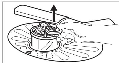
2. Вийміть фільтр (C) із фільтру (B).
