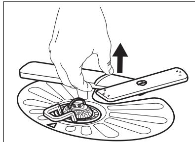
2. Вимийте розпилювач під проточною водою. Використовуйте тонкий гострий предмет, наприклад зубочистку, щоб виділити з отворів частки забруднень.
