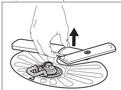
2. Промойте разбрзыватель под струей воды. Для прочистки отверстий от частиц грязи воспользуйтесь заостренным предметом (например, зубочисткой).
