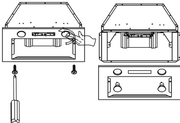
5) Установите вытяжку в шкаф и закрепите 8 винтами (ST4 x 18mm), после чего установите панель переключения на место.
