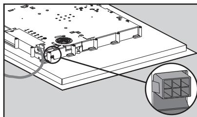
La memoria inalámbrica se puede utilizar con placas de cocción que tengan el símbolo < en la esquina superior izquierda de la superficie de la placa (excepto KM 549 y KM 554). En las placas de cocción equipadas con la conexión Miele@home que se representa en la figura se puede conectar directamente la memoria inalámbrica. Para el resto de modelos, es necesario un adaptador que podrá adquirir a través del Servicio Post-Venta.
