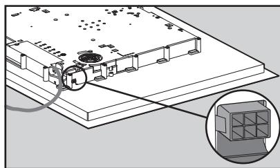
Stik lahko uporabite pri kuhalnih ploščah, ki imajo v levem zgornjem kotu steklokeramične plošče simbol @ (izjemi KM 549 in KM 554).
