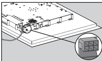
Telsiz cam seramik ocağın sol üst köşesinde symbolü bulunan ocaklıarda kullanılabilir (KM 549 ve KM 554 modeller dışında).
