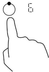
2. Выключите варочную зону, установив значение мощности на «0». Убедитесь, что на дисплее отображается «0», а затем «Н».
