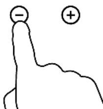
4. Нажмите кнопку «-» - таймер будет отменен. На дисплее отобразится «00».
