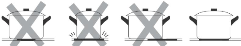
Снимая посуду с варочной поверхности поднимайте ее вверх, а не двигайте по поверхности, т.к. поверхность прибора может поцарапаться.
