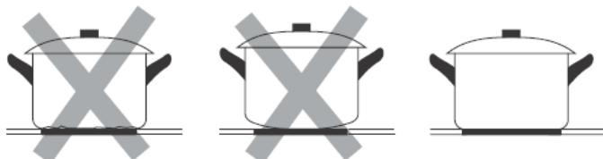
Убедитесь, что поверхность дна посуды гладкая, плотно прилегает к поверхности варочной панели, а диаметр дна соответствует диаметру варочной зоны. При использовании посуды с дном большего диаметра будет расходоваться большее количество энергии. Если Вы используете посуду с меньшим диаметром дна, то эффективность использования энергии может быть меньше, чем ожидалось. Посуда с диаметром дна менее 140 мм может быть не распознана прибором. Всегда ставьте посуду по центру варочной зоны.
