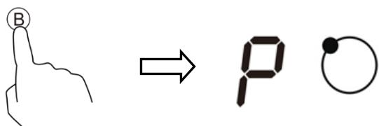
3. Режим усиленного нагрева будет работать в течение пяти минут, затем варочная зона примет настройки мощности, установленные до включения этого режима.
