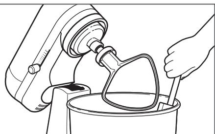
Не чистите чашу пока настольный миксер работает. Чаша и лопатки разработаны для обеспечения тщательного смешивания без частой очистки боковых сторон чаши. Одной или двух очисток при смешивании обычно бывает достаточно.
