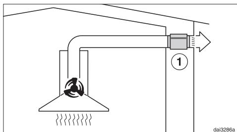
Шумоподавитель уменьшает звук работающего вентилятора, а также внешние шумы, которые могут проникать на кухню через воздуховод
