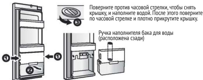
**Осторожно** Бак для воды устанавливается и вводится в эксплуатацию на заводе-изготовителе. Если вам необходимо прочистить его, ознакомьтесь с разделом «Очистка бака для воды», чтобы предотвратить его поломку.
