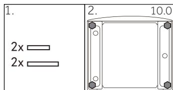
3. Достаньте шумоподавляющие подушки и снимите защитную плёнку двухсторонней ленты, наклейте ее с нижней стороны, как указано на рисунке 3(1 и 3 две более длинные подушки, 2 и 4 две более короткие подушки).
