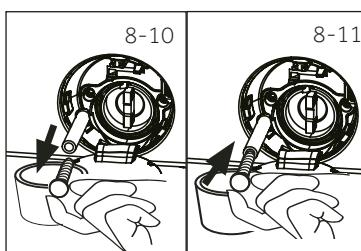
3. Подставьте плоскую емкость для слива воды (рис. 8-10). Объемы воды могут быть большими!
