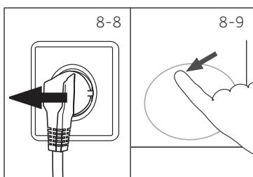
1. Выключите стиральную машину и выньте штепсельную вилку из розетки (рис. 8-8).
