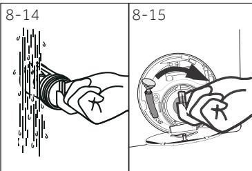
9. Осторожно очистите фильтр насоса, например, с помощью проточной воды (рис. 8-14).
