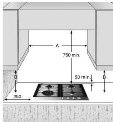
Примечание: Если расстояние "A" между кухонными шкафами составляет от 600 мм до 730 мм, высота "B" должна быть не менее 530 мм. Если расстояние "A" между кухонными шкафами больше ширины варочной панели, высота "B" должна быть не менее 400 мм.
