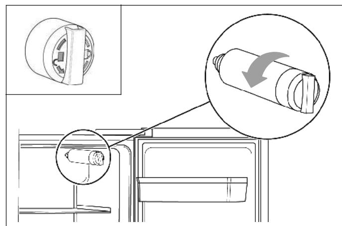
2. Открутите старый фильтр для воды против часовой стрелки (см. маркировку на фильтре) и снимите его.
