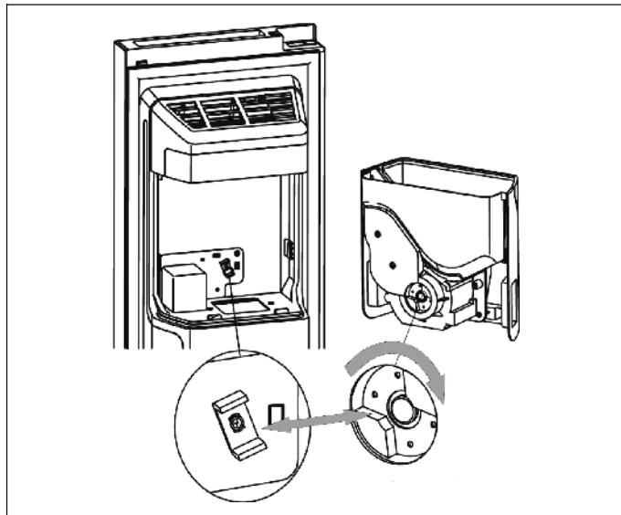
1. Убедитесь, что оба соединения расположены под правильным углом и сцепляются друг с другом. При необходимости поверните муфту сцепления контейнера для льда так, чтобы она соединялась со сцеплением мотора.
