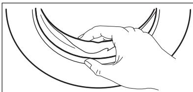
Регулярно проверяйте состояние уплотнителя и удаляйте все предметы с его внутренней стороны.
