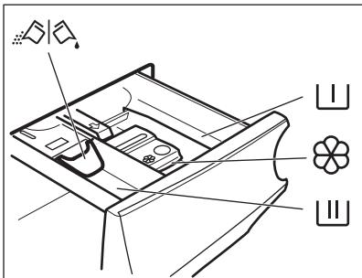
Отделение для моющего средства, используемого на этапе предварительной стирки, замачивания или выведения пятен.
