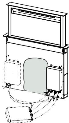
**⚠ Atención...: No instalar el producto dejando la caja eléctrica en contacto con el pavimento.**
