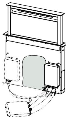
**⚠ Attention : ne pas installer le produit en laissant le boîtier électrique au contact du sol.**
