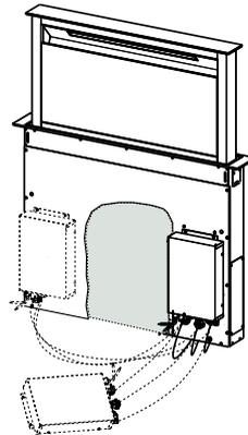
**⚠ Achtung:** Bei der Installation darf die Abzweigdose nicht in Kontakt mit dem Fußboden bleiben.
