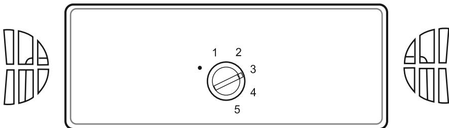
Der Thermostat regelt automatisch die Temperatur im Inneren des Kühlschranks. Durch Ändern der Reglerstellung von Position 1 bis 5 können niedrigere Temperaturen erreicht werden.
