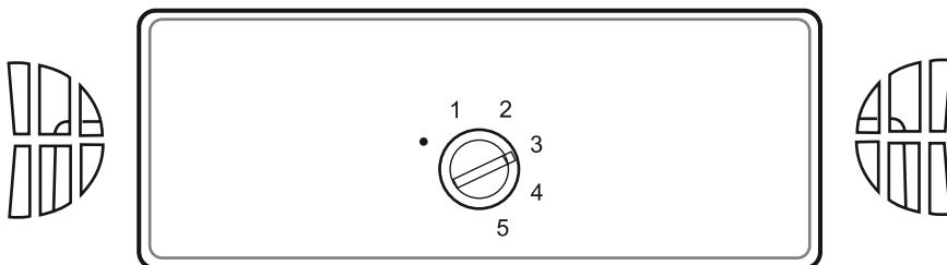
Термостат автоматически регулирует температуру внутри холодильника. путем изменения позиции ручки с положения 1 до 5 можно получить более низкие значения температуры.
