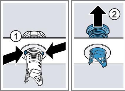
5. Промойте фильтрующие элементы проточной водой.
