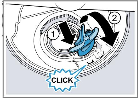
✓ Крышка насоса фиксируется со щелчком.
