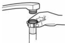
Подключите шланг для подачи холодной воды к соединительному колену с резьбой  $\frac{3}{4}$  дюйма; при этом следите за прочностью соединения. Если трубы новые или не использовались в течение длительного времени, дайте воде стечь, пока она не станет прозрачной. Данная мера необходима для предотвращения засорения канала для подачи воды и повреждения прибора.
