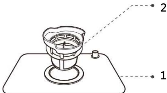
Для Вашего удобства мы поместили сливной насос и систему фильтров в легкодоступном месте внутри отсека. Фильтрующая система состоит из трех компонентов: основной фильтр, грубый фильтр и тонкий фильтр.
