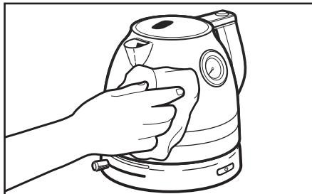
Протрите электрочайник и основание влажной тканью. Затем протрите его поверхность насухо мягкой тканью. Не рекомендуется использовать абразивные и моющие средства.
