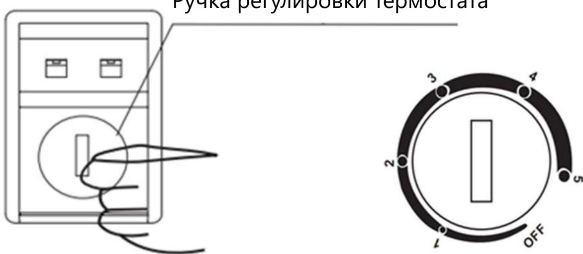
Температура морозильной камеры регулируется с помощью ручки, установленной на термостате. Цифры указанные на термостате «1, 2, 3, 4, 5» не обозначают конкретную температуру. Чем меньше цифра, тем выше температура:
