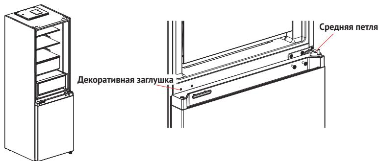
4. Снимите дверь морозильной камеры, немного приподняв её. Демонтируйте нижнюю петлю, используя ключ и крестовую отвёртку. Отрегулируйте уровень на ножках, как показано на рисунке ниже. Перекиньте штырёк петли на противоположную сторону петли.
